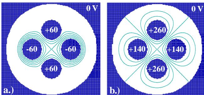
**Figure 3.** Equipotential contours for a quadrupole with grounded housing: a.) 0 Volt pole bias. b.) 200 Volt pole bias.
